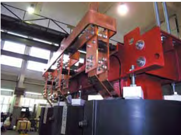
Присоединение по ВН и НН шинами сбоку через изоляционные пластины
